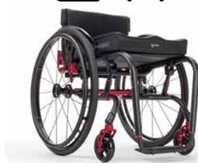
ETHOS – Eine neue Ära im Rollstuhldesign: Die zum Patent angemeldete Iso Tech isoliert den Sitzrahmen mithilfe von schwingungsdämpfenden Polymeren vollständig vom Grundrahmen. Der Ethos bietet dadurch konkurrenzlose Fahrqualität kombiniert mit einem attraktiven, auffallend geformten Design.
